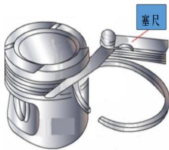
图 16 塞环侧隙检测示意图
