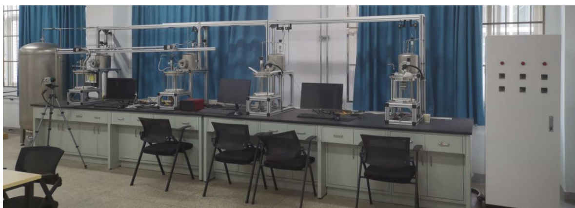
图 15 课程中穿插教师科研（闪蒸与表面沸腾实验台）
